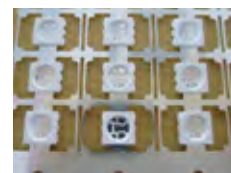
電子部品 LED リフレクター (光の取り出し効率を上げる反射板)
