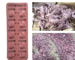
PTPシート(左)をプラスチック(右上)とアルミ箔に分解(右下)
