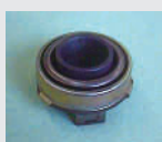
自動車部品 クラッチスリーブベアリング (アルミ軸を支える滑り軸受け)
